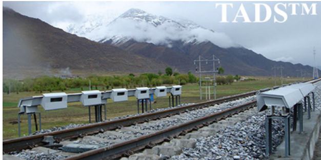
Рис. 4. Система акустичного виявлення колії (TADS)
